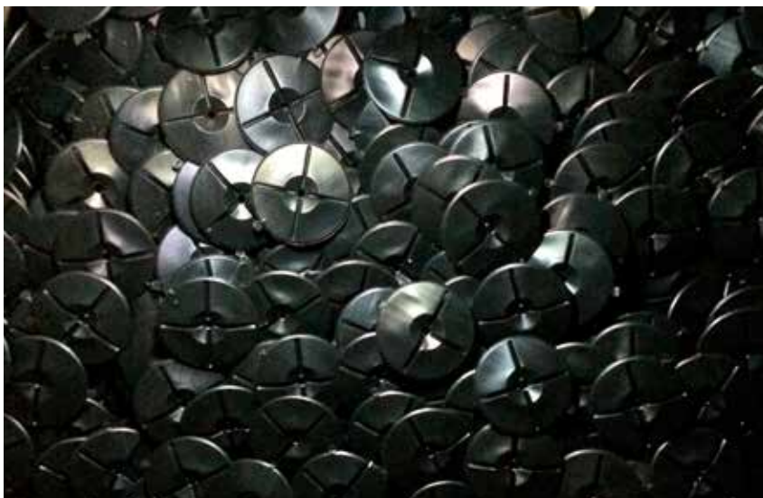
Stora kylklampar ger frikyla med hjälp av så kallad PCM-teknik, phase-change material.
