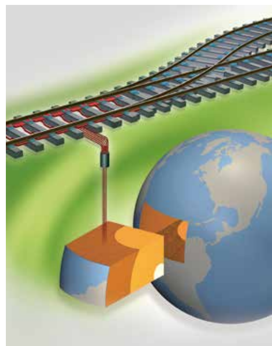
Koldioxiden värms av marken och stiger uppåt till tågväxeln. Där avges värmen när gasen kondenserar. Ingen el eller värmepump behövs.
