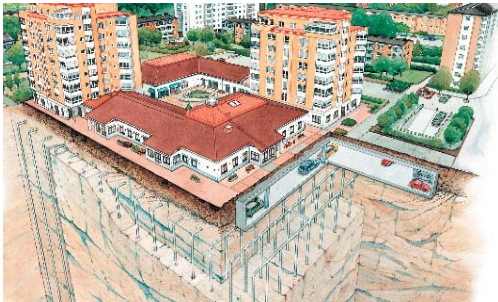
Bild 4: Borrhålslager för kombinerad försörjning av värme och kyla.
