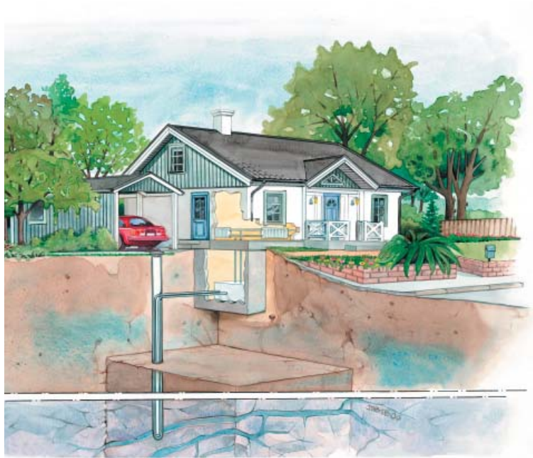
Bild 2: Bergvärme, ofta till en enskild villa i tätbebyggelse, hämtar värme från berget.
