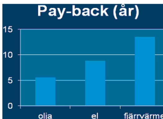
Bild 4: Beräknad rak återbetalningstid för geoenergi med 7 kW värmepump som ersätter uppvärmning med olja, elpanna och fjärrvärme.
