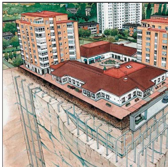
Bild 3: Seasonal Performans Factor (SPF) för bergvärme (t. v.) är typiskt 3-4 och för ett borrhålslager (t. h.) 5-7.
